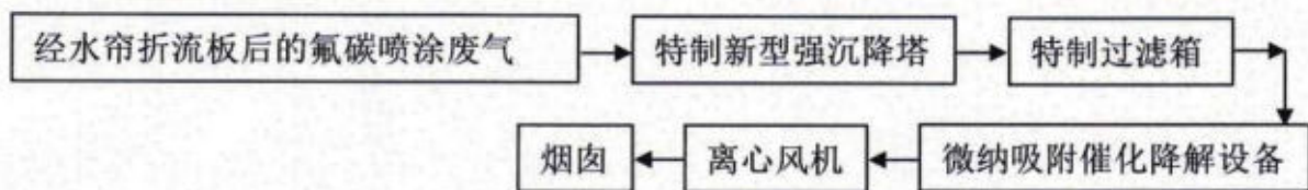
图 6.2-2 喷漆房废气处理流程图
